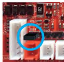
Максимальная чувствительность – перемычка установлена
