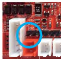
Минимальная чувствительность – перемычка удалена
